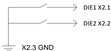
Anschlusschema digitaler Eingänge
