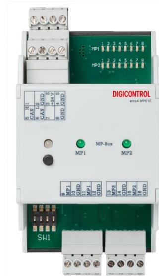
Das Modul ems4.MP01E dient zur direkten Ansteuerung von MP-busfähigen Belimo Antrieben. Hierfür verfügt das Modul über zwei unabhängige MP-Bus Stränge die jeweils eine Kommunikation mit bis zu 16 MP-Bus-Antrieben ermöglicht. Das Modul ermittelt selbständig die Geschwindigkeit des angeschlossenen CAN-Bus-Systems.
