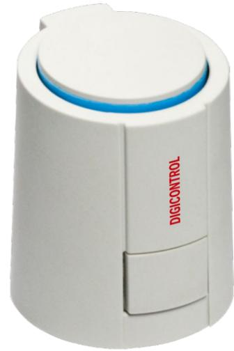
Thermoelektrische Stellantriebe zum Öffnen und Schließen von Kleinventilen an Heizkreisverteilern von Flächenheiz- und Flächenkühlssystemen. Die Ansteuerung der Antriebe erfolgt mit Zwei-Punkt-Ausgang oder Pulsweiten-Modulation von einer Automationsstation der Baureihe DIGICONTROL ems... oder einem Raumbediengerät der Baureihe DIGICONTROL R4D.
