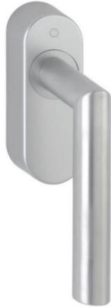
Batterieloser EnOcean Funk-Fenstergriff (optional abschließbar) zur Erfassung des Fensterzustands. Bei Betätigung sendet der Griff ein Funksignal mit der Griffposition an einen Aktor oder zentrale Steuerungseinheit, um beispielsweise eine Energiesperre zu aktivieren. So kann der Energieverbrauch im Gebäude optimiert werden, da bei geöffneten Fenster die Heizung oder Lüftung deaktiviert wird.
