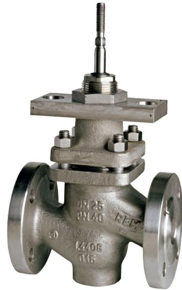
Einsetzbar in Gebäude- und Prozesstechnik für unterschiedliche Medien von 0...+200 °C. Mit Stopfbuchsverlängerung oder Edelstahlaltbalg einsetzbar von -10...+350 °C und bei austenitischem Stahlguss von -30...+350 °C. Mit Spindelheizung geeignet für Wasser mit Frostschutz bis -10 °C und bei austenitischem Stahlguss bis -30 °C.
