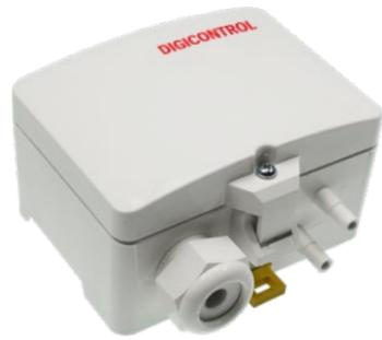
Der Differenzdruck-Messumformer mit 8 einstellbaren Messbereichen und den analogen Ausgangssignalen 0...10 V und 4...20 mA dient zur Erfassung von Differenzdrücken von Luft und andere nicht entflammare und nicht aggressive Gase. Mögliche Einsatzgebiete sind die Überwachung von Luftfiltern, Gebläsen, industriellen Kühlluftkreisen und Strömungen in Lüftungskanälen.
