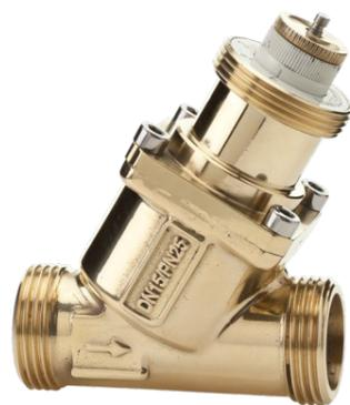
V-VARIO-DC ist ein druckunabhängiges Regelventil. Es regelt unabhängig von Druckschwankungen im Netz den eingestellten Volumenstrom. Einstellung unabhängig vom Ventilhub für exakte Ansteuerung über das gesamte Eingangssignal. Der Volumenstrom ist stufenlos einstellbar über Feineinstellrad. Einstellungen sind von außen ablesbar. Anschluss M30 x 1,5 für Antriebe der Baureihe S-KVA und VARIOPULSE-VP.
