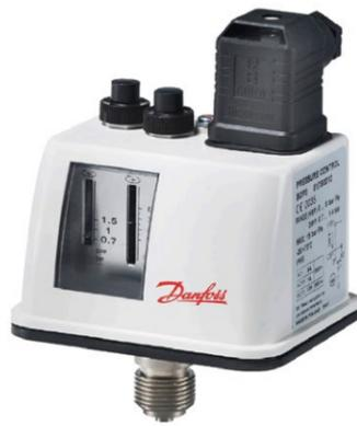
Bei R-BCP-Druckbegrenzern handelt es sich um eine Serie spezieller Druckbegrenzer für die Sicherheits- und Drucküberwachung von Dampf- und Heißwasserkesseln. Im R-BCP ist ein Mikroschalter als einpoliger Wechsler integriert, bei dem die Kontaktstellung vom Eingangsdruck in Bezug auf den eingestellten Schalterpunkt abhängt. Bei Anlagen, in denen der Betrieb aus Sicherheitsgründen besonders kritisch ist, wird die Verwendung eines ausfallsicheren Reglers (Failsafe- Ausführung) empfohlen.
