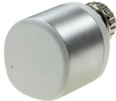
Batterieloser funkgesteuerter Ventilstellantrieb für Einzelraumregelung. Der elektronische Kleinstellantrieb nutzt die Temperaturdifferenz zwischen warmen Heizkörper und kühlerem Raum, um elektrische Energie mittels eines thermoelektrischen Generators zu gewinnen.
