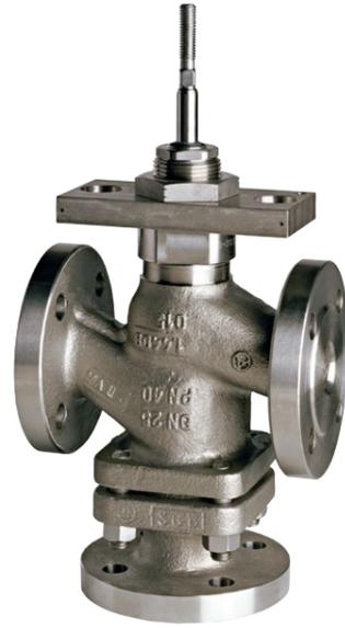
Einsetzbar in Gebäude- und Prozesstechnik für unterschiedliche Medien von 0...+200 °C. Mit Stopfbuchsverlängerung oder Edelstahlfa­ltenbalg einsetzbar von -10...+350 °C und bei austenitischem Stahlguss von -30...+350 °C. Mit Spindelheizung geeignet für Wasser mit Frostschutz bis -10 °C und bei austenitischem Stahlguss bis -30 °C.
