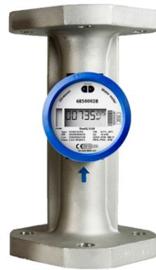
Ultraschall-Wasserzähler zur Messung und Registrierung von Wasserverbrauch. Rechenwerk mit RTC und M-Bus-Modul nach EN 13757 mit zwei zusätzlichen Impulseingängen, Anschlusskonsole und optischer Schnittstelle. Netzbetrieb 230 V AC mit erweiterter Protokollierung und Datenlogger. Ultraschall-Durchflusssensor inkl. 2,5 m Verbindungskabel und Gewindeanschluss-teilen.
