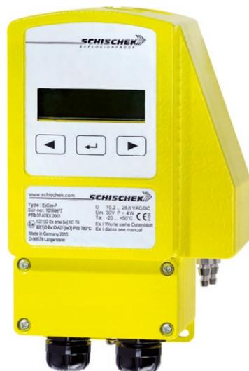
ExCos-P... sind Drucksensoren für die Lufttechnik, z.B. für Differenzdruckregelungen. Eine Volumenstrommessung ist vom Hersteller und der Geometrie bzw. der Konstruktion der Luftklappe abhängig. Ein Einsatz ist im Vorfeld abzustimmen!
