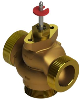
Einsetzbar in Heizungs-, Lüftungs- und Klimaanlage zur Regelung des Heiß- und Kaltwasserdurchflusses von 0...+150 °C. Ab 130 °C Antriebsposition nur waagrecht zulässig. Mit Spindelheizung und Niroinnenteilen geeignet für Wasser mit Frostschutz bis -15 °C. Ventile in den Endlagen dichtschießend.
