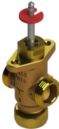
Einsetzbar in Heizungs-, Lüftungs- und Klimaanlage zur Regelung des Heiß- und Kaltwasserdurchflusses von 0...+150 °C. Ab 130 °C Antriebsposition nur waagrecht zulässig. Mit Spindelheizung und Niroynteilen geeignet für Wasser mit Frostschutz bis -15 °C. Ventile in den Endlagen dichtschießend.
