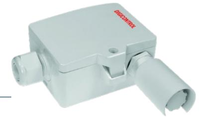
Der F-AFTF-T ist zur Messung von Feuchte und Temperatur im Außenbereich. Im Auslieferungszustand ist der Fühler zur Messung von Temperatur und relativer Feuchte ausgelegt. Alternativ kann auch absolute Feuchte, Enthalpie oder Taupunkt ausgegeben werden.
