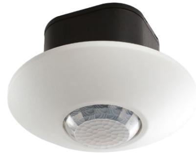
Der Funk-Decken-Multisensor R4D.BW-LS dient zur Bewegungserfassung und Helligkeitsmessung in Wohn- oder Büroräumen. Die Übertragung erfolgt mittels Funk-Telegrammen gemäß EnOcean-Standard an den Empfänger
