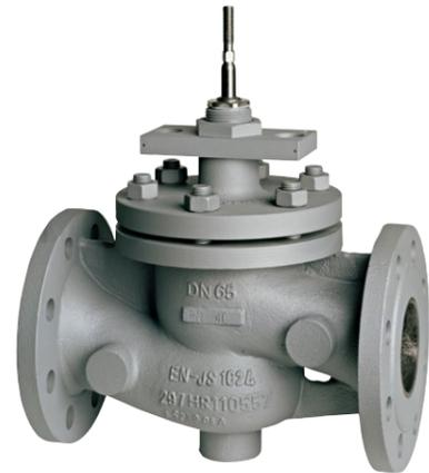
Einsetzbar in Gebäude- und Prozesstechnik für unterschiedliche Medien von 0...+200 °C. Mit Stopfbuchsverlängerung oder Edelstahlfaltbalg einsetzbar von -10...+350 °C und bei austenitischem Stahlguss von -30...+350 °C. Mit Spindelheizung geeignet für Wasser mit Frostschutz bis -10 °C und bei austenitischem Stahlguss bis -30 °C.
