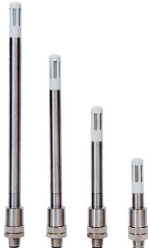
ExPro-B... Sensoren sind für Temperatur- und/oder Feuchtemessung im Ex-Bereich geeignet und ausschließlich zusammen mit einem ExBin-D... Modul einsetzbar!
