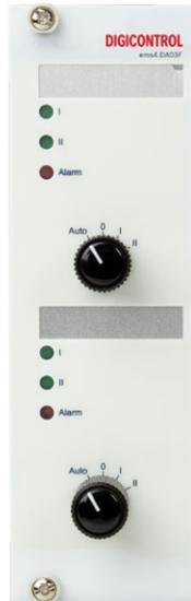
ems4.DA03F ist ein Modul für das Schalten von bis zu 2 x 2-stufigen Relaisausgängen mit LVB (Lokale Vorrangbedienebene) in 19"-Ausführung für den Einbau in die Schaltschrankfront sowie mit integriertem Mikrocontroller und Speicher für die Aufnahme eines speziell für dieses Modul abgestimmten Programms.
