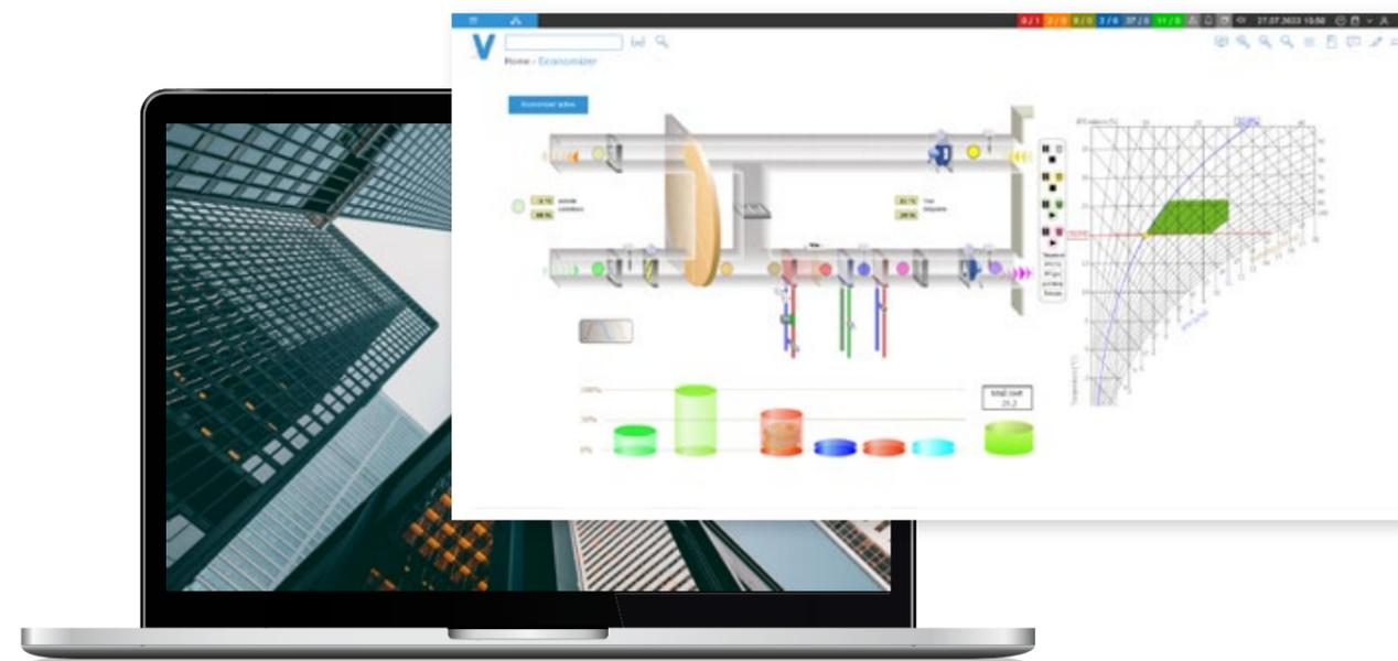
In um den DIGICONTROL Economizer erweiterten Klimaanlage protokollierten wir über das Jahr gerechnete Energieeinsparungen in Höhe von 15 bis 69,5%. Der patentierte Algorithmus optimiert RLT-Anlagen durch rechnerisches Perfektionieren der Strategie zur Ausnutzung des Behaglichkeitsfeldes und Ansteuerung der Luftbehandlung, entwickelt in Kooperation mit Prof. Dr. Sokollik, Hochschule Merseburg.
