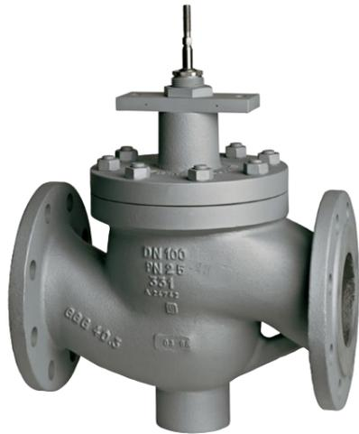
Einsetzbar in Gebäude- und Prozesstechnik für unterschiedliche Medien von 0...+200 °C. Mit Stopfbuchsverlängerung oder Edelstahlaltbalg einsetzbar von -10...+350 °C und bei austenitischem Stahlguss von -30...+350 °C. Mit Spindelheizung geeignet für Wasser mit Frostschutz bis -10 °C und bei austenitischem Stahlguss bis -30 °C.
