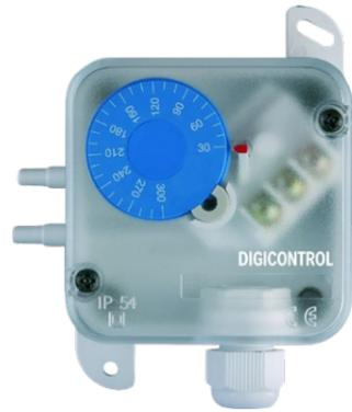
Einstellbarer Differenzdruckschalter zur Überwachung des Differenzdrucks von Luft und anderen nicht brennbaren und nicht aggressiven Gasen. Mögliche Einsatzgebiete sind die Überwachung von Luftfiltern, Gebläsen, industriellen Kühlluftkreisen und Strömungen in Lüftungskanälen.
