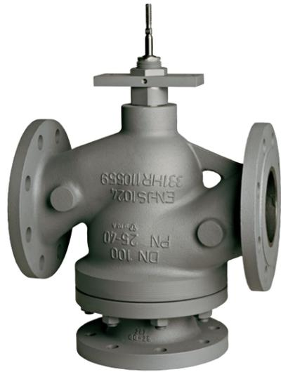
Einsetzbar in Gebäude- und Prozesstechnik für unterschiedliche Medien von 0...+200 °C. Mit Stopfbuchsverlängerung oder Edelstahlfallenbalg einsetzbar von -10...+350 °C und bei austenitischem Stahlguss von -30...+350 °C. Mit Spindelheizung geeignet für Wasser mit Frostschutz bis -10 °C und bei austenitischem Stahlguss bis -30 °C.
