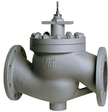
Einsetzbar in Gebäude- und Prozesstechnik für unterschiedliche Medien von 0...+200 °C. Mit Stopfbuchsverlängerung oder Edelstahlfallenbalg einsetzbar von -10...+350 °C und bei austenitischem Stahlguss von -30...+350 °C. Mit Spindelheizung geeignet für Wasser mit Frostschutz bis -10 °C und bei austenitischem Stahlguss bis -30 °C.
