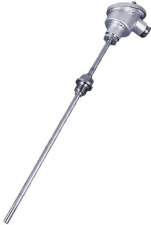
Einschraubtauchfühler zur Messung speziell höherer Temperaturen in flüssigen und gasförmigen Medien von Heizungs-, Lüftungs- und Klimaanlage sowie in Abgasanlagen. Ausgestattet mit Halsrohr. Ausgelegt zur Aufschaltung auf Regler- und Anzeigesysteme.
