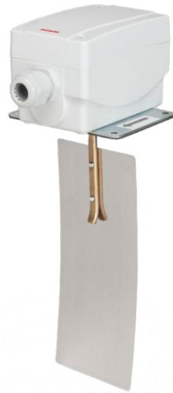
Der R-WFS-1EPL ist zur Strömungsüberwachung von gasförmigen Medien in Luft- und Klimakanälen, in Zu- oder Abluftgeräten von Ventilatoren oder elektrischen Heizregistern (auch bei verschmutzter, ölhaltiger Luft) oder als Durchflusswächter und Luftströmungswächter einsetzbar.
