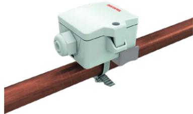
Der F-ALTF-T im Klappdeckel-Gehäuse USE zur Messung der Temperatur an Rohren und gewölbten Oberflächen. Das Messelement wird über einen Federmechanismus auf die Messfläche gedrückt, um so einen direkten Kontakt und schnelles Ansprechverhalten zu erzielen. Ausgelegt zur Aufschaltung auf Regler- und Anzeigesysteme.
