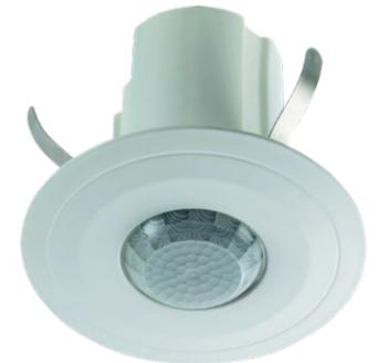
Der Decken-Multisensor F-RBH-T mit Bewegungserfassung und Lichtmessung dient zur Realisierung einer Konstantlichtregelung in Innenräumen. Über die Detektion von anwesenden Personen kann eine energieeffiziente Lichtregelung oder auch die Temperaturabsenkung in unbenutzten Räumen realisiert werden. Durch die flache Bauform eignet sich das Gerät für den unauffälligen Einbau in Zwischendecken.
