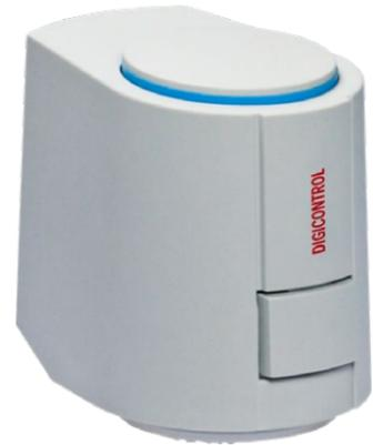
Thermoelektrische Stellantriebe zur diskreten Steuerung von Heiz- und Kühlsystemen im direkten Verhältnis zur angelegten Steuerspannung. Die Ansteuerung der Antriebe erfolgt per 0...10 V DC-Signal von einer Automationsstation der Baureihe DIGICONTROL ems... oder einem Raumbediengerät der Baureihe DIGICONTROL R4D.
