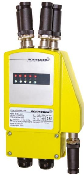
ExBin-A Module sind Schaltverstärker zum direkten Einbau im Ex-Bereich mit 1-, 2- oder 5 Kanälen, zum Anschluss von 1, 2 oder 5 passiven potentialfreien binären Sensoren und werden in RLT-Anlagen eingesetzt.
