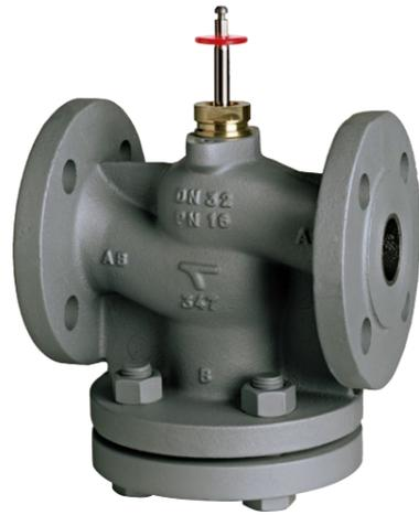
Einsetzbar in Heizungs-, Lüftungs- und Klimaanlage zur Regelung des Heiß- und Kaltwasserdurchflusses von 0...+150 °C. Ab 130 °C Antriebsposition nur waagrecht zulässig. Mit Spindelheizung geeignet für Wasser mit Frostschutz bis -10 °C. Die Ventile sind in den Endlagen dichtschießend.
