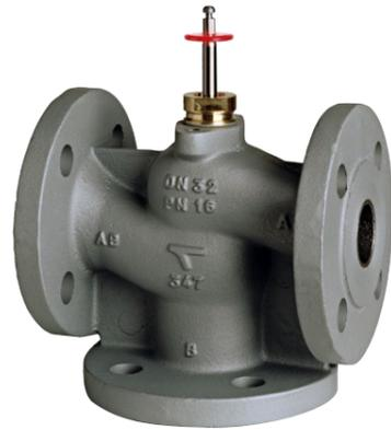
Einsetzbar in Heizungs-, Lüftungs- und Klimaanlage zur Regelung des Heiß- und Kaltwasserdurchflusses von 0...+150 °C. Ab 130 °C Antriebsposition nur waagrecht zulässig. Mit Spindelheizung geeignet für Wasser mit Frostschutz bis -10 °C. Die Ventile sind in den Endlagen dichtschießend.
