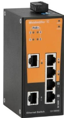
Der Switch bietet eine Lösung für den Einsatz von Power over Ethernet. 4 x IEEE 802.3af/at konforme PoE-Ports, mit integriertem DC/DC-Wandler zur Speisung von 48 V PoE-Geräten über den gesamten Eingangsspannungsbereich von 24 bis 48 VDC, intelligente Stromaufnahmeerkennung und Einstufung.
