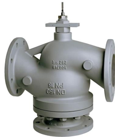
Einsetzbar in Gebäude- und Prozesstechnik für unterschiedliche Medien von 0...+200 °C. Mit Stopfbuchsverlängerung oder Edelstahlfallenbalg einsetzbar von -10...+350 °C und bei austenitischem Stahlguss von -30...+350 °C. Mit Spindelheizung geeignet für Wasser mit Frostschutz bis -10 °C und bei austenitischem Stahlguss bis -30 °C.
