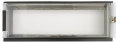
Der Trägerrahmen ems4.TRSF wird zum Einbau von max. 10 Stück ems4-Frontmodulen mit je 8TE und 3HE verwendet. Er ist mit 4 Schrauben M6 in der Schaltschranktüre zu befestigen. Die Schnittkanten werden durch den umlaufenden Rahmen abgedeckt. Schutzklasse IP54 durch umlaufende Polyurethan-Dichtung.
