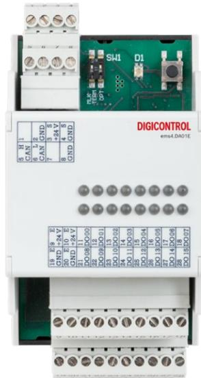
Das Ausgangsmodul ermöglicht das Schalten von 1...16 digitalen Ausgängen (Transistorausgänge). Jeweils für zwei Ausgänge wird ein gemeinsames Statussignal angeboten über das z.B. ein Kurzschluss am Ausgang diagnostiziert werden kann. Jeder Ausgang des ems4.DA01E verfügt über besondere Schutzmechanismen:
