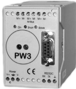
Die M-Bus-Konverter der Baureihe DC-PW... sind Pegelwandler / Master zum Betrieb von M-Bus-Netzwerken mit bis zu 250 Standard-Endgeräten.
