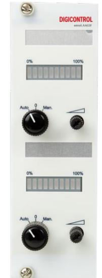
Analoges Ausgangsmodul 19" mit LVB für Fronteinbau
