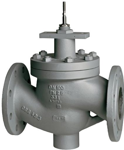
Einsetzbar in Gebäude- und Prozesstechnik für unterschiedliche Medien von 0...+200 °C. Mit Stopfbuchsverlängerung oder Edelstahlfaltenbalg einsetzbar von -10...+350 °C und bei austenitischem Stahlguss von -30...+350 °C. Mit Spindelheizung geeignet für Wasser mit Frostschutz bis -10 °C und bei austenitischem Stahlguss bis -30 °C.
