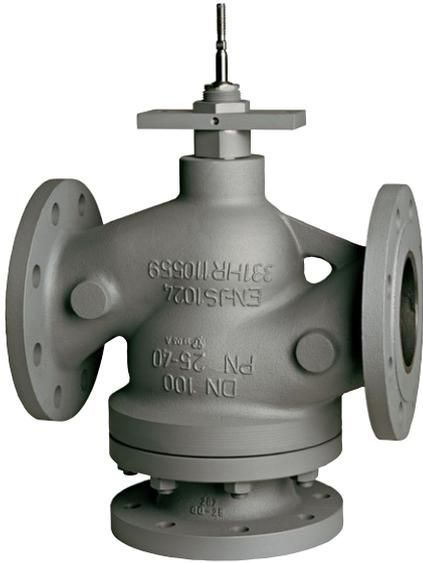
Einsetzbar in Gebäude- und Prozesstechnik für unterschiedliche Medien von 0...+200 °C. Mit Stopfbuchsverlängerung oder Edelstahlfaltenbalg einsetzbar von -10...+350 °C und bei austenitischem Stahlguss von -30...+350 °C. Mit Spindelheizung geeignet für Wasser mit Frostschutz bis -10 °C und bei austenitischem Stahlguss bis -30 °C.
