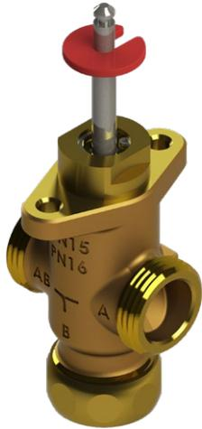
Einsetzbar in Heizungs-, Lüftungs- und Klimaanlage zur Regelung des Heiß- und Kaltwasserdurchflusses von 0...+150 °C. Ab 130 °C Antriebsposition nur waagrecht zulässig. Mit Spindelheizung und Niroinnenteilen geeignet für Wasser mit Frostschutz bis -15 °C. Ventile in den Endlagen dichtschießend.
