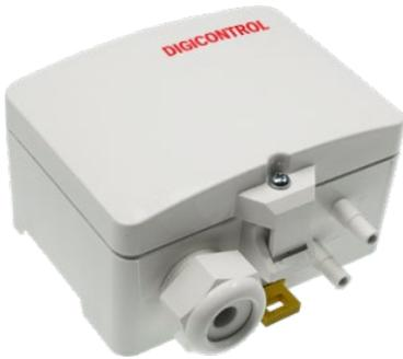
Der Differenzdruck-Messumformer mit 8 einstellbaren Messbereichen und den analogen Ausgangssignalen 0...10 V und 4...20 mA dient zur Erfassung von Differenzdrücken von Luft und andere nicht entflammbar und nicht aggressive Gase. Mögliche Einsatzgebiete sind die Überwachung von Luftfiltern, Gebläsen, industriellen Kühlluftkreisen und Strömungen in Lüftungskanälen.
