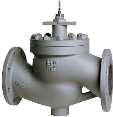
Einsetzbar in Gebäude- und Prozesstechnik für unterschiedliche Medien von 0...+200 °C. Mit Stopfbuchsverlängerung oder Edelstahlaltenbalg einsetzbar von -10...+350 °C und bei austenitischem Stahlguss von -30...+350 °C. Mit Spindelheizung geeignet für Wasser mit Frostschutz bis -10 °C und bei austenitischem Stahlguss bis -30 °C.
