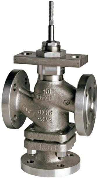
Einsetzbar in Gebäude- und Prozesstechnik für unterschiedliche Medien von 0...+200 °C. Mit Stopfbuchsverlängerung oder Edelstahlfaltbalg einsetzbar von -10...+350 °C und bei austenitischem Stahlguss von -30...+350 °C. Mit Spindelheizung geeignet für Wasser mit Frostschutz bis -10 °C und bei austenitischem Stahlguss bis -30 °C.
