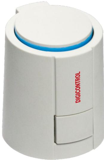
Thermoelektrische Stellantriebe zum Öffnen und Schließen von Kleinventilen an Heizkreisverteilern von Flächenheiz- und Flächenkühlssystemen. Die Ansteuerung der Antriebe erfolgt mit Zwei-Punkt-Ausgang oder Pulsweiten-Modulation von einer Automationsstation der Baureihe DIGICONTROL ems... oder einem Raumbediengerät der Baureihe DIGICONTROL R4D.
