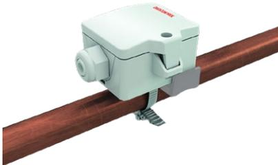
Der F-ALTF-T im Klappdeckel-Gehäuse USE zur Messung der Temperatur an Rohren und gewölbten Oberflächen. Das Messelement wird über einen Federmechanismus auf die Messfläche gedrückt, um so einen direkten Kontakt und schnelles Ansprechverhalten zu erzielen. Ausgelegt zur Aufschaltung auf Regler- und Anzeigesysteme.
