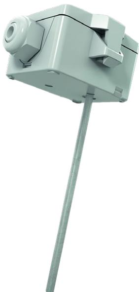
Der Kanal-/Tauchfühler ist zur Temperaturmessung in gasförmigen Medien von Heizungs-, Lüftungs- und Klimaanlage. In Verbindung mit einer Tauchhülse ist er auch zur Messung in flüssigen Medien (z.B. Rohrleitungssystemen) geeignet.
