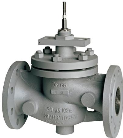
Einsetzbar in Gebäude- und Prozesstechnik für unterschiedliche Medien von 0...+200 °C. Mit Stopfbuchsverlängerung oder Edelstahlfaltenbalg einsetzbar von -10...+350 °C und bei austenitischem Stahlguss von -30...+350 °C. Mit Spindelheizung geeignet für Wasser mit Frostschutz bis -10 °C und bei austenitischem Stahlguss bis -30 °C.
