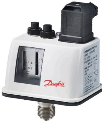
Bei R-BCP-Druckbegrenzern handelt es sich um eine Serie spezieller Druckbegrenzer für die Sicherheits- und Drucküberwachung von Dampf- und Heißwasserkesseln. Im R-BCP ist ein Mikroschalter als einpoliger Wechsler integriert, bei dem die Kontaktstellung vom Eingangsdruck in Bezug auf den eingestellten Schaltpunkt abhängt. Bei Anlagen, in denen der Betrieb aus Sicherheitsgründen besonders kritisch ist, wird die Verwendung eines ausfallsicheren Reglers (Failsafe- Ausführung) empfohlen.
