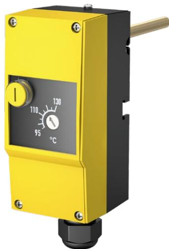
Zum Regeln und Überwachen der Temperatur von Flüssigkeiten in Bädern, Behältern, Rohrleitungen und Kanälen. Durch modularen Aufbau als Anlege-, Stab-, Doppelthermostat oder als Thermostat mit Fernfühler einsetzbar. Es gibt Varianten als Temperaturwächter (TW), Sicherheitstempewächter (STW), Temperaturbegrenzer (TB) oder Sicherheitstempewächter (STB). Zum Lieferumfang gehört eine Messingtauchhülse in 100 mm Länge.
