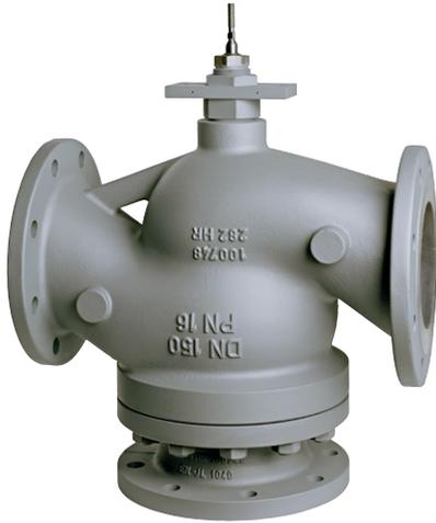
Einsetzbar in Gebäude- und Prozesstechnik für unterschiedliche Medien von 0...+200 °C. Mit Stopfbuchsverlängerung oder Edelstahlaltenbalg einsetzbar von -10...+350 °C und bei austenitischem Stahlguss von -30...+350 °C. Mit Spindelheizung geeignet für Wasser mit Frostschutz bis -10 °C und bei austenitischem Stahlguss bis -30 °C.
