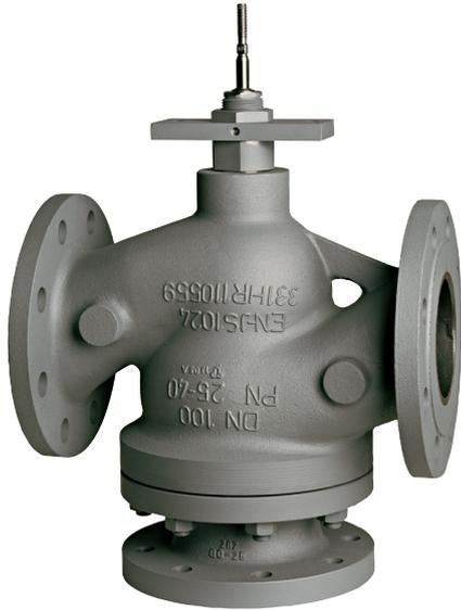
Einsetzbar in Gebäude- und Prozesstechnik für unterschiedliche Medien von 0...+200 °C. Mit Stopfbuchsverlängerung oder Edelstahlfaltbalg einsetzbar von -10...+350 °C und bei austenitischem Stahlguss von -30...+350 °C. Mit Spindelheizung geeignet für Wasser mit Frostschutz bis -10 °C und bei austenitischem Stahlguss bis -30 °C.
