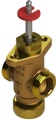
Einsetzbar in Heizungs-, Lüftungs- und Klimaanlage zur Regelung des Heiß- und Kaltwasserdurchflusses von 0...+150 °C. Ab 130 °C Antriebsposition nur waagrecht zulässig. Mit Spindelheizung und Niroinnenteilen geeignet für Wasser mit Frostschutz bis -15 °C. Ventile in den Endlagen dichtschließend.
