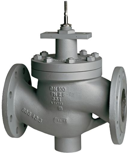
Einsetzbar in Gebäude- und Prozesstechnik für unterschiedliche Medien von 0...+200 °C. Mit Stopfbuchsverlängerung oder Edelstahlfaltbalg einsetzbar von -10...+350 °C und bei austenitischem Stahlguss von -30...+350 °C. Mit Spindelheizung geeignet für Wasser mit Frostschutz bis -10 °C und bei austenitischem Stahlguss bis -30 °C.
