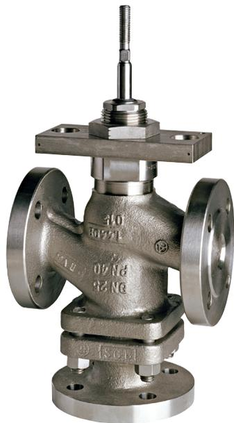
Einsetzbar in Gebäude- und Prozesstechnik für unterschiedliche Medien von 0...+200 °C. Mit Stopfbuchsverlängerung oder Edelstahlfallenbalg einsetzbar von -10...+350 °C und bei austenitischem Stahlguss von -30...+350 °C. Mit Spindelheizung geeignet für Wasser mit Frostschutz bis -10 °C und bei austenitischem Stahlguss bis -30 °C.
