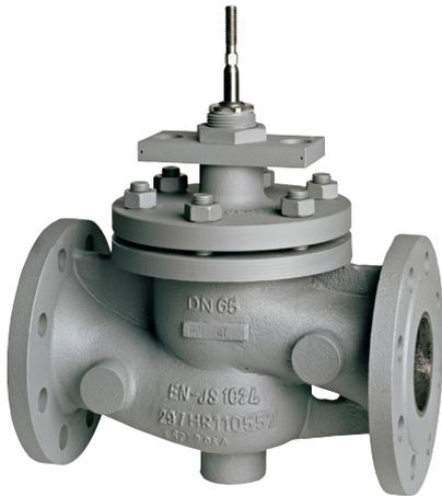
Einsetzbar in Gebäude- und Prozesstechnik für unterschiedliche Medien von 0...+200 °C. Mit Stopfbuchsverlängerung oder Edelstahlfallenbalg einsetzbar von -10...+350 °C und bei austenitischem Stahlguss von -30...+350 °C. Mit Spindelheizung geeignet für Wasser mit Frostschutz bis -10 °C und bei austenitischem Stahlguss bis -30 °C.
