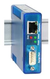
Der DC-COM-Serv wird als Trägerprotokollwandler zur Umsetzung eines Standard M-Bus oder Modbus auf Ethernet TCP/IP eingesetzt. Die serielle Schnittstelle des Servers kann zwischen den Standards RS232, RS422 und RS485 umgeschaltet werden. Im Lieferumfang sind 1x Com-Server Highspeed Industry und 1x Produkt-CD enthalten.
