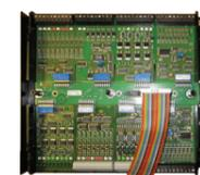
CPU wurde entfernt, Anbindung der verbleibenden AS-Hardware mittels System-Flachbandkabel
