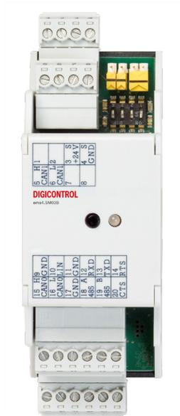
Das Modul ems4.SM03B dient als Kommunikationsschnittstelle mit 1 x RS232 / RS485, 2x CAN zur Anbindung von busfähigen Fremdkomponenten wie z.B.: U-Pumpen, Wärmepumpen, Kältemaschinen, Befeuchter, Kessel, Solaranlagen, Fernster, etc.
