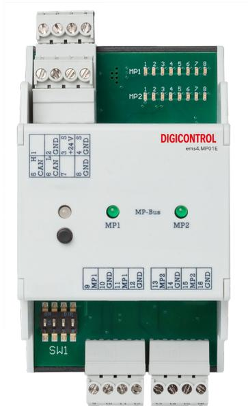
Das Modul ems4.MP01E dient zur direkten Ansteuerung von MP-busfähigen Belimo Antrieben. Hierfür verfügt das Modul über zwei unabhängige MP-Bus Stränge die jeweils eine Kommunikation mit bis zu 16 MP-Bus-Antrieben ermöglicht. Das Modul ermittelt selbständig die Geschwindigkeit des angeschlossenen CAN-Bus-Systems.
